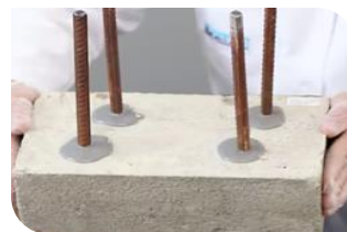
Ancoragem de aço em concreto em furos verticais.
